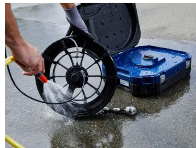
Быстрая очистка для долговечной гигиены: промойте корпус и толкатель водой перед установкой на место в корпусе кейса
