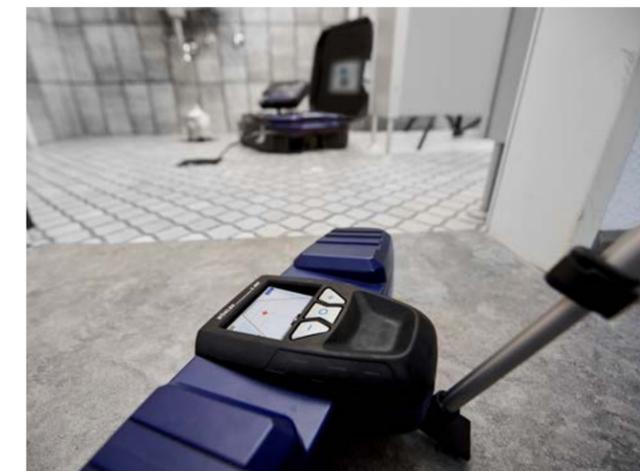
Точное позиционирование головки камеры с локатором Wohler L 200
